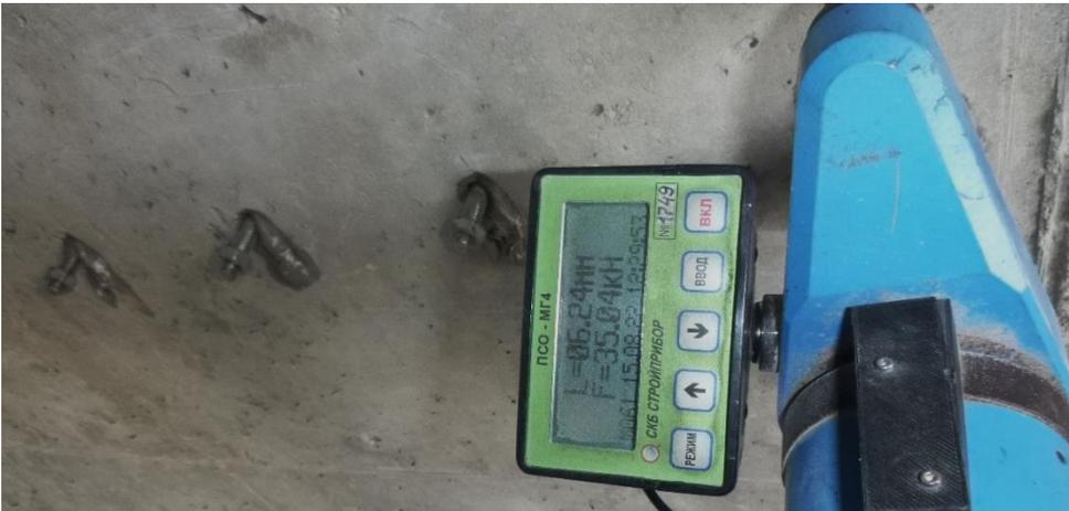
По результатам испытаний разрушение идет по основанию либо шпильке.
