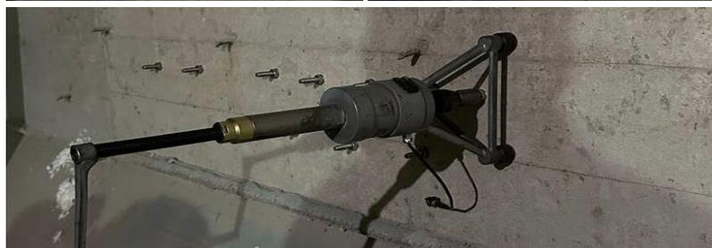
(Анкер-болт нерж. сталь А4 АМТ3-А4 М10-35/115; монолитный железобетон)
